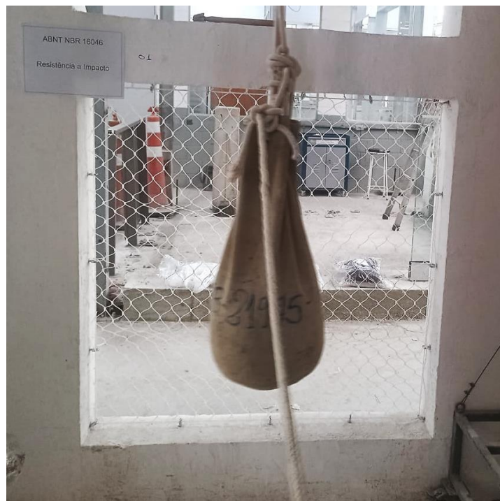
Foto n.º 01 – Visualização do ensaio de resistência ao impacto
